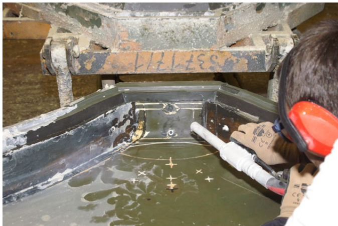
A szárazjég-szóró technológia használata óta hatalmas időmegtakarítás tapasztalható.
